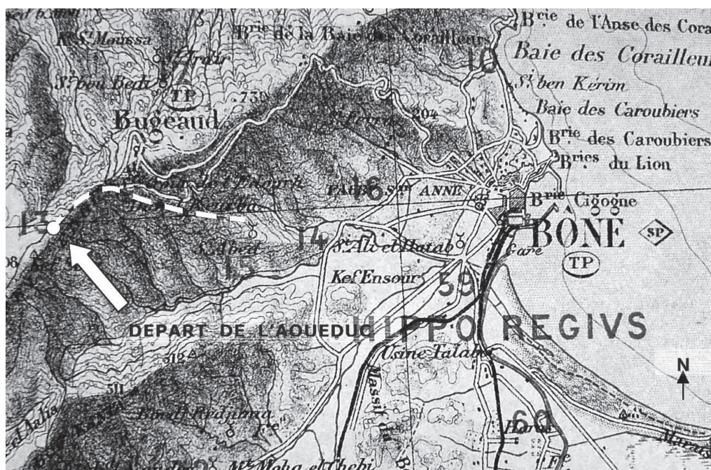
Fig. 8: Tracé de l'aqueduc d'Hippone (en pointillé, à droite de notre flèche) (d'après Gsell, 1911, F. 9).
