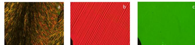
Textures observées au Microscope optique polarisant pour 16-OPIA. (a) Phase cristalline (Cr) à 113°C, (b) Phase smectique (Sm) à 136°C et (c) Phase nématique (N) à 150°C.
