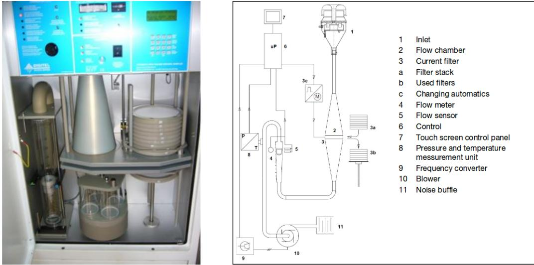
FIGURE 4.1 – échantilleur Digitel DA80 utilisé pour l’acquisition de données (source du tracé de droite : Digitel).
