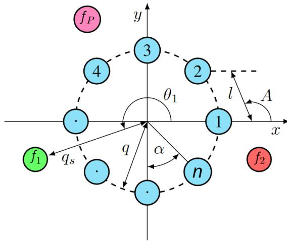
FIGURE 6.7 – Configuration du réseau circulaire de microphones. Les microphones sont numérotés de 1 à  $n$  et les sources sonores sont notées  $f_1$  à  $f_p$ .
