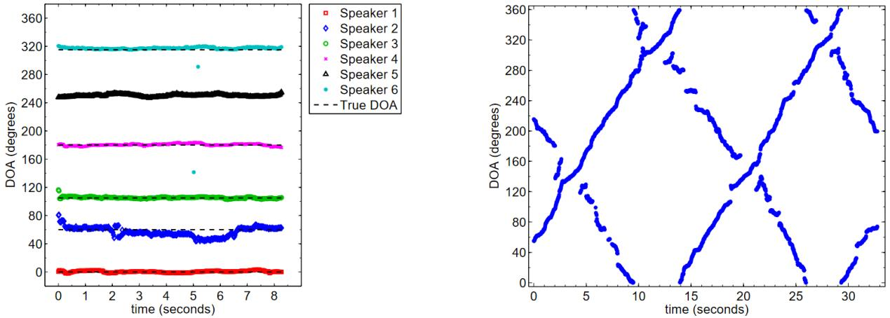
FIGURE 6.11 – Expériences réalisées en conditions réelles. A gauche : localisation de 6 sources statiques. A droite : localisation de 2 sources tournant autour du réseau.
