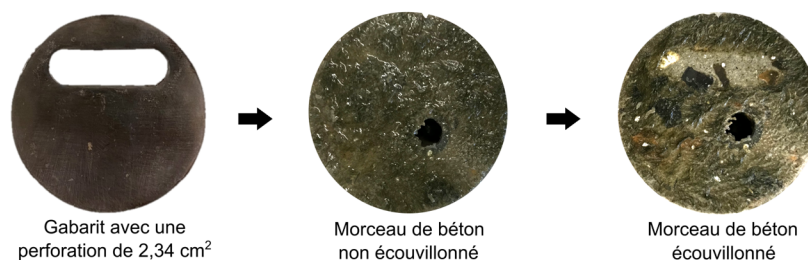
Figure 25 : Photographies du gabarit, permettant d'écouvillonner une surface définie, et d'un morceau de béton avant et après écouvillonnage de la surface.
